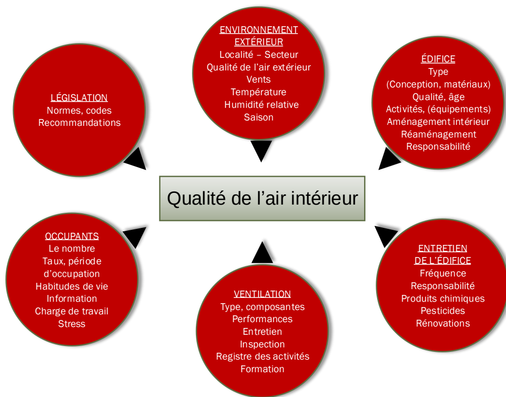
Figure 1 : Principaux paramètres conditionnant la qualité de l'air intérieur.
